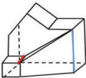
对比选项发现，A项和B项的俯视图一致，C项和D项的俯视图一致，两种俯视图的区别在于梯形内部是否有条直线，观察立体图形，发现应该有条直线（标红的线），排除C项和D项。A项和B项中的侧视图，都有条斜线在图形左边，如果是从左向右看，那么斜线应该在图形的右边，所以侧视图应该是从右向左看到的图形，对比A项和B项中的侧视图，有两点区别：①A项中斜线的下边没有线，而B项中斜线的下边有条直线；②A项中间的竖线与底边有交点，B项中间的竖线与底边没有交点。看两个区别都可以做出题目，但是看中间的竖线更明显，如图中所示，竖线（标蓝的线）与底边有交点，排除B项。
